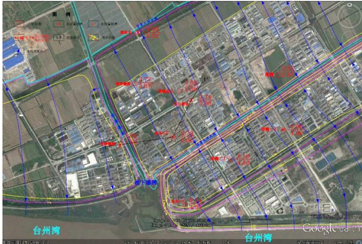
图 3.3-4 潜水流网图（地下水流向自北往南）
